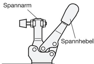
Durch die Anwendung des **Kniehebelprinzips** weisen Schnellspanner entscheidende Vorteile auf:
