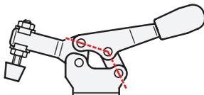
Bereits eine kleine Drehung des Spannhebels führt den Spannarm mit der Andrückschraube an das Werkstück heran.
